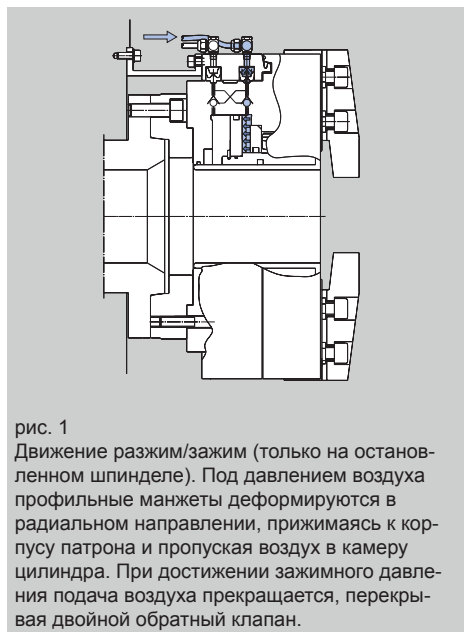
рис. 2 Эластичные SMW-профильные манжеты принимают исходное положение, отходя от корпуса патрона. Зажимное давление поддерживается за счет двойного обратного клапана. Патрон может начинать вращение.
