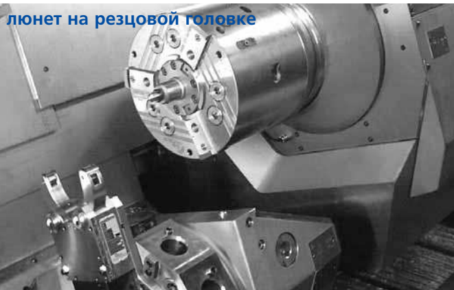
люнет для обработки валов в авиастроении
