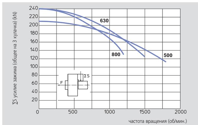
Данные на диаграмме относятся к новому 3-х кулачковому патрону, установленному по сервисной инструкции с применением SMW-AUTOBLOK смазки K05. Статическое и динамическое усилие зажима измерялось на стандартных мягких накладных кулачках, не выступающих за диаметр патрона.
